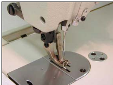
Máquina extra fuerte de aguja sencilla, puntada de doble pespunte.
