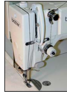
Máquina Regular de aguja sencilla puntada, de doble pespunte
