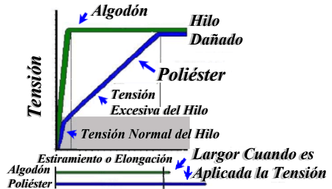
Figura 4. Elongación o Estiramiento cuando Tensión es Aplicada
