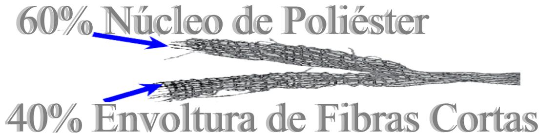
**Figura 1. Hilo de Fibrofilamentos - 60 % Núcleo de Poliéster con un 40% Envoltura de fibras cortas**
